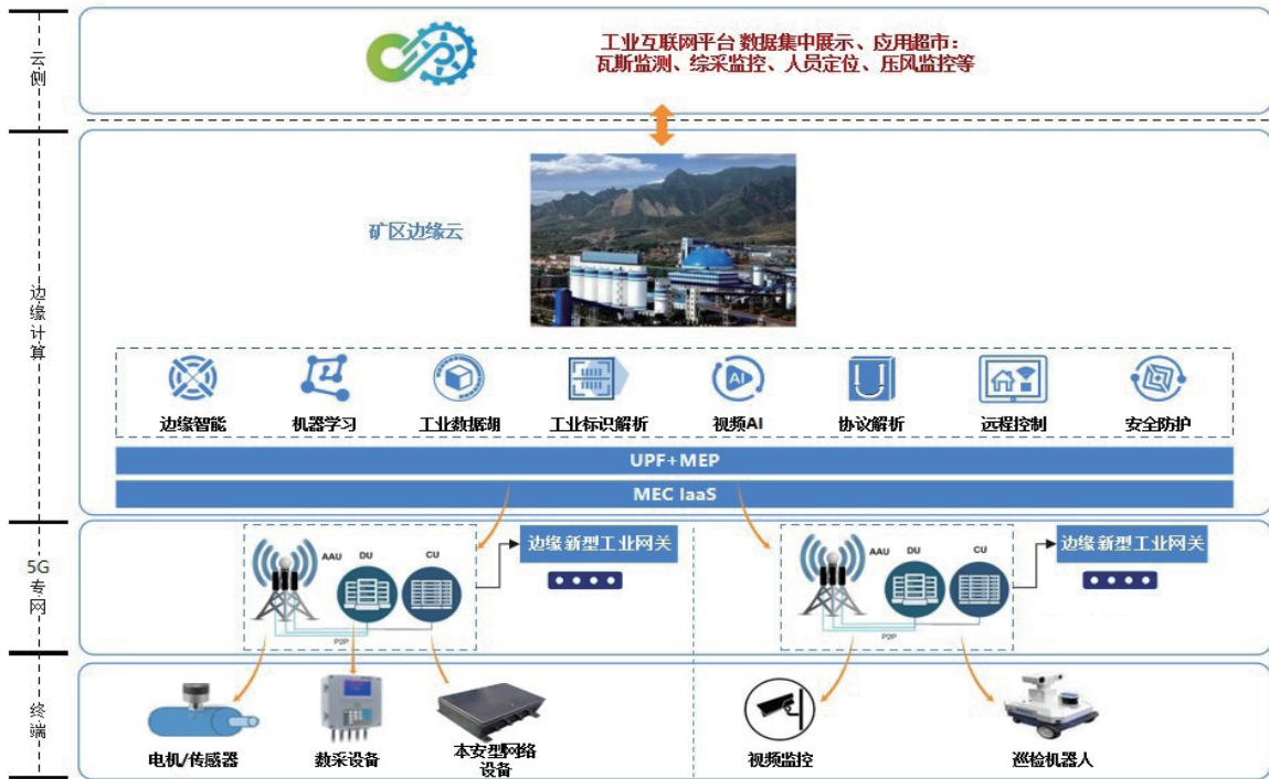
图 2-2 工业互联网云边协同典型架构
