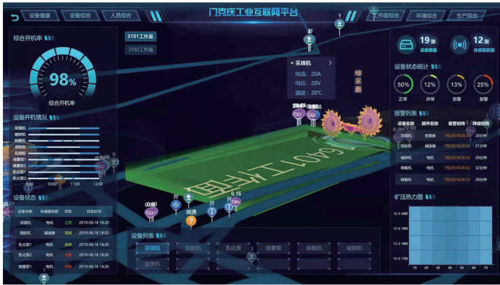
图 3-19 门克庆煤矿工业互联网平台综采工作面界面
