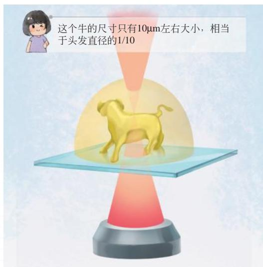
图 7 双光子聚合技术的原理示意图
