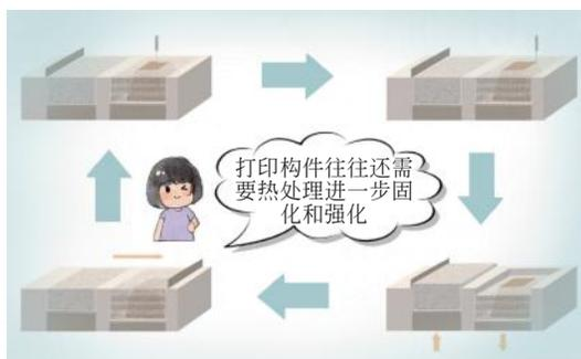
图 5 黏结剂喷射成型的原理示意图
