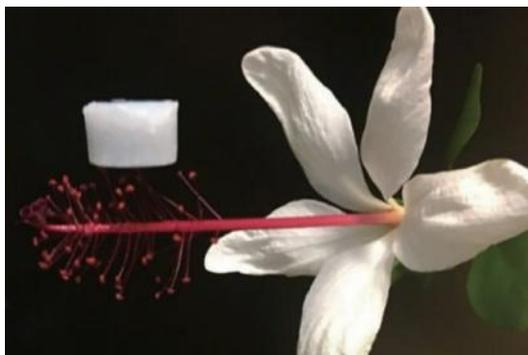
图7 超轻无机（陶瓷）气凝胶<sup>[12]</sup>
