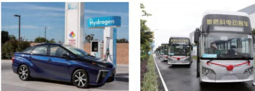
图6 氢燃料电池汽车
