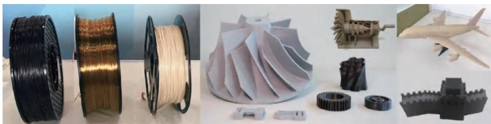
图 3 新型石墨烯特种树脂基 3D 打印复合线材及制件
