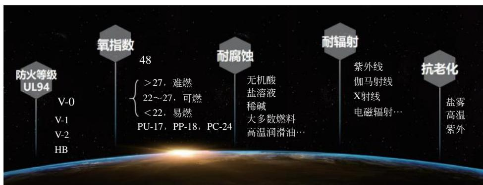
图 5 新型石墨烯特种树脂基 3D 打印复合材料环境耐受度情况
