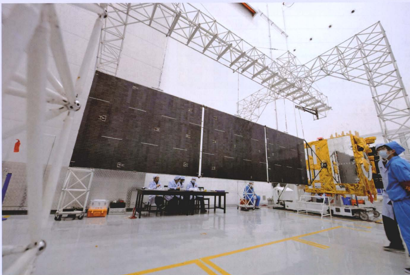
▲ “北斗” 导航卫星进行太阳电池翼展开试验
