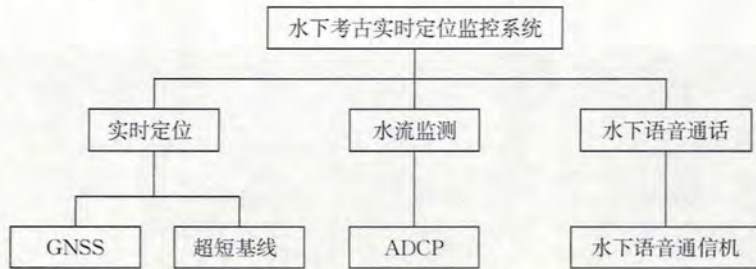
图 10 水下考古实时定位监控系统的结构
