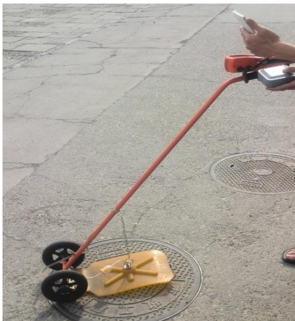
图 4 燃气精准泄漏检测
